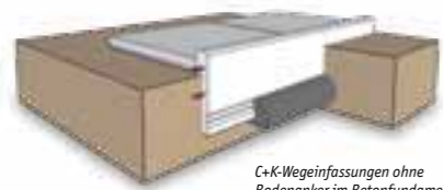
C+K-Wegeinfassungen ohne Bodenanker im Betonfundament. C+K Path borderings without ground anchor.
