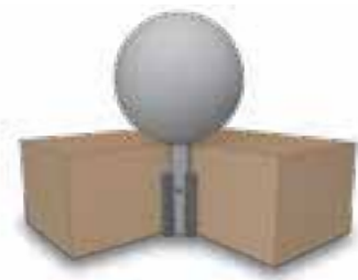
Einfundamentierung der C+K-Kugel mit Hilfe des Bodenankers. Globes embedded in concrete by means of the ground anchors.
