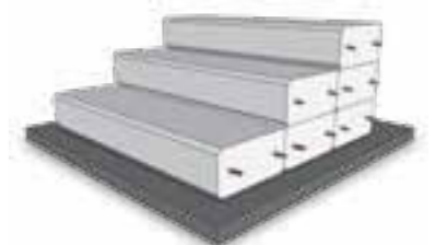
Verklebung der Blockstufe als Stufenanlage auf festem Untergrund. Gluing the block step in staircase on a firm substrate.
