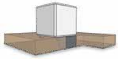
Einfundamentierung des C+K-Würfels mit Hilfe des Bodenankers. Cubes embedded in concrete by means of the ground anchors.
