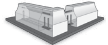
Aufstellen der C+K-Hockeybande mit Hilfe des Eckelements. Positioning the hockey board with the aid of the corner element.
