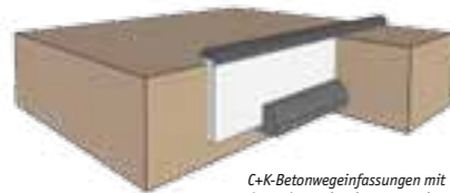
C+K-Betonwegeinfassungen mit Gummigranulatüberzug werden bodengleich eingebaut. C+K Concrete path bordering with rubber granule coating are built on grade.
